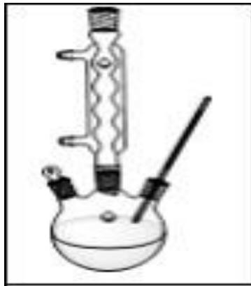
Gambar 2.5 Seperangkat alat refluks (Sumber: Supaya, 2019)
