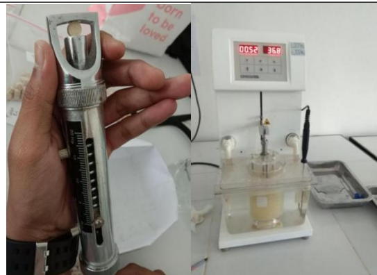
Uji kekerasan dan disintegrasi
