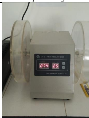
Pengujian Kerapuhan menggunakan friability tester
