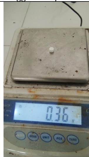
Pengujian Keseragaman bobot menggunakan timbangan analitik
