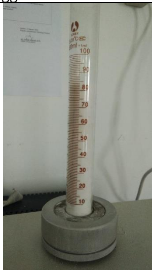
Pengujian Kompresibilitas menggunakan tap density
