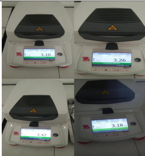
Pengujian Kadar Lembab Menggunakan moisture analyzer
