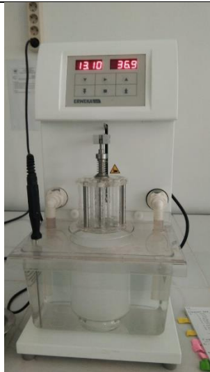
Pengujian waktu hancur menggunakan disintegration tester
