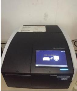
Gambar instrument spektrofotometri UV-Vis
