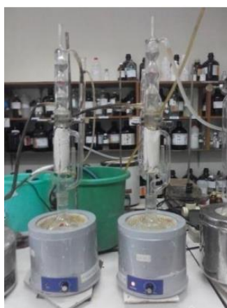
Gambar 2.13 Alat ekstraksi sokletasi (Zain et al. , 2016)
