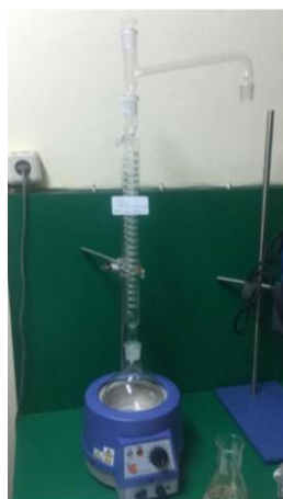
Gambar 2.14 Alat ekstraksi refluks (Hidayat et al. , 2019)
