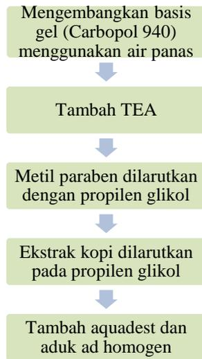
Gambar 5. 1 proses pembuatan sediaan gel
