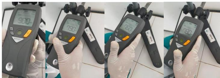
Gambar 5. 6 hasil uji viskositas
