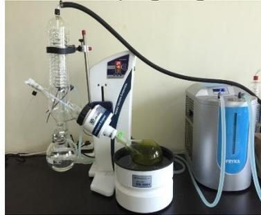
(Gambar 2. Proses evaporasi ekstrak cair)
