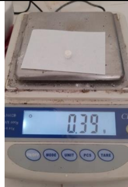
Pengujian Keseragaman bobot menggunakan timbangan analitik
