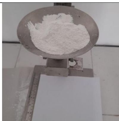
Pengujian Kecepatan alir dan Sudut diam menggunakan flow tester
