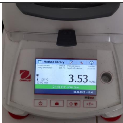
Pengujian Kadar Lembab Menggunakan moisture analyzer
