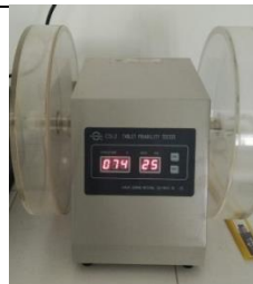
Pengujian Kerapuhan menggunakan friability tester
