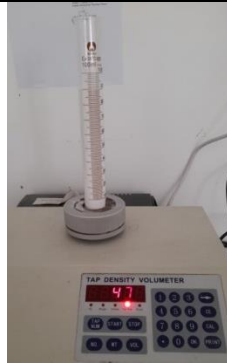
Pengujian Kompresibilitas menggunakan tap density
