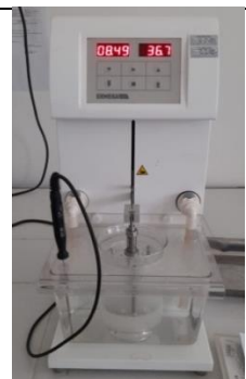
Pengujian waktu hancur menggunakan disintegration tester
