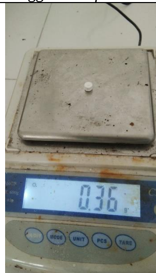
Pengujian Keseragaman bobot menggunakan timbangan analitik
