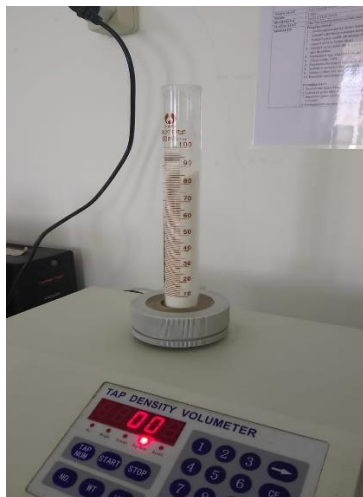
Pengujian Kompresibilitas menggunakan tap density
