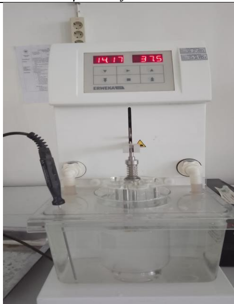
Pengujian waktu hancur menggunakan desintegration tester
