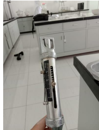
Pengujian Kekerasan menggunakan hardness tester
