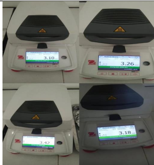
Pengujian Kadar Lembab Menggunakan moisture analyzer
