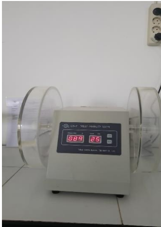
Pengujian Kerapuhan menggunakan friability tester
