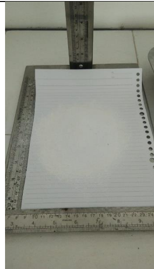
Pengujian Kecepatan alir dan Sudut diam menggunakan flow tester
