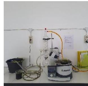
6. Proses pemekatan dengan *Rotary Evaporator*
