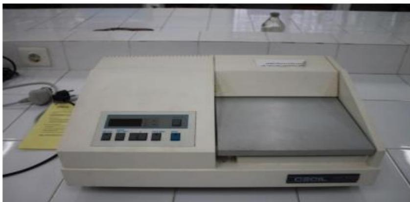
Gambar 2.5 Spektrofotometer Uv-Vis (Deviyanti, 2019)
