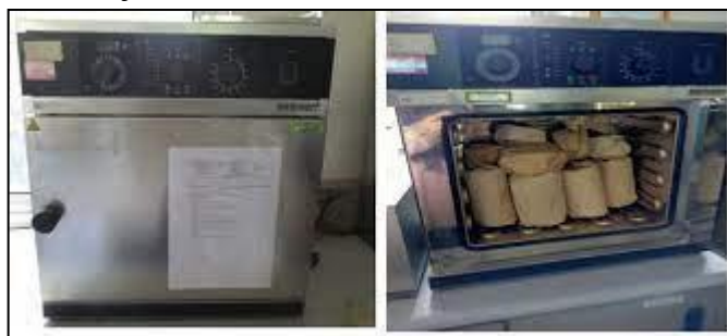
Gambar 3. Sterilisasi Panas Kering dengan Oven
