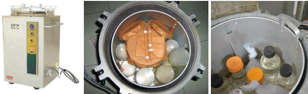
Gambar 4. Sterilisasi Panas Basah dengan Autoklaf
